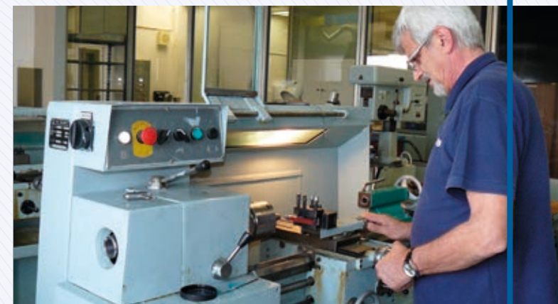
Výroba přípravku na soustruhu. Production of a fixture on a lathe.
